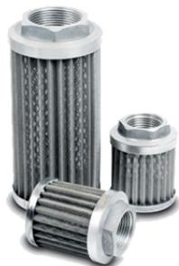
**Filtros de Sucção:** Sua função é a proteção da bomba da contaminação do fluido. São localizados antes da entrada da bomba. Caracterizam-se por elementos abertos, com grau de retenção relativamente elevado devido aos limites da cavitação das bombas.
